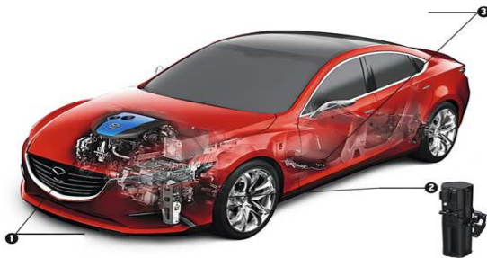
Hình 1: Sơ đồ bố trí hệ thống i-ELOOP
