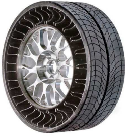
Hình 5: Lốp không hơi Tweel của Michelin năm 2006 chỉ phù hợp với xe quân dụng
