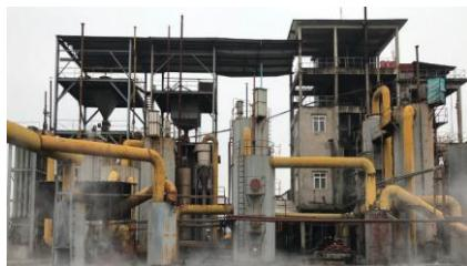
**Hình 3:** Hệ thống lò than hóa khí của nhà máy gốm màu
