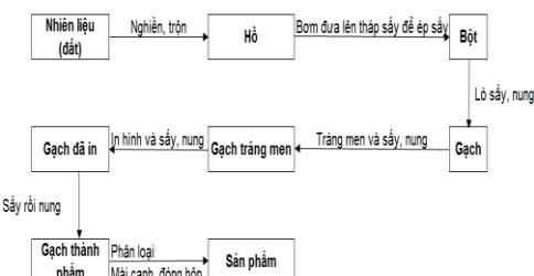
**Hình 2:** Quy trình sản xuất gạch của nhà máy
