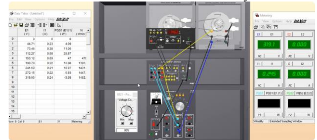
Hình 12. Kết quả mô phỏng khi thay đổi điện áp đặt vào động cơ.
