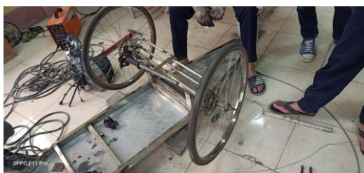
Hình 11. Gia công hình thang lái và tính toán tăng kích thước hai trục trước của xe
