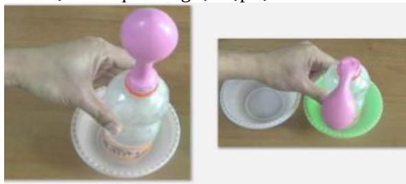
Hình 9. Các bước của TN thổi phồng quả bóng bằng nước nóng
