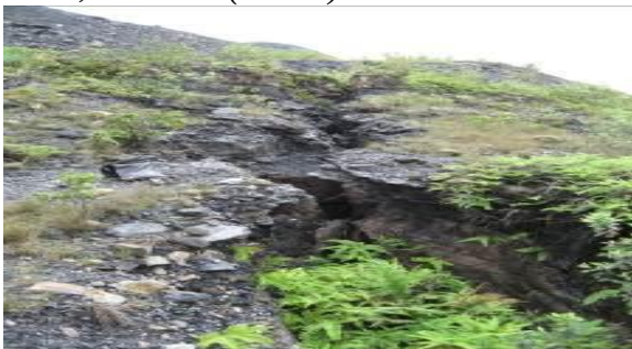
Hình 3. Khe nứt trượt phát triển tại khu vực trung tâm trên cao trình +240÷260m
