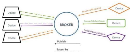
Hình 1. Mô hình mạng sử dụng giao thức MQTT
