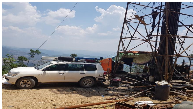
Hình 3. Trạm đo Địa vật lý Roberson Geologging đang tiến hành đo ngoài thực địa
